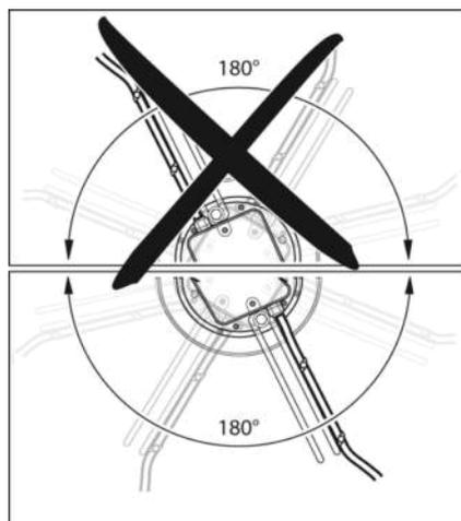
Illustr. 1: Pose des câbles pour ventilateurs montés debout. Les câbles doivent toujours arriver par le bas.
