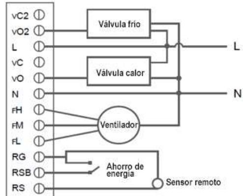
Fig. 4. Honeywell VC4013/VN4013/VS4016 Cableado
