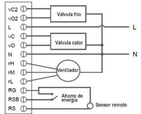
Fig. 5. Honeywell VC6013/VN6013 Cableado
