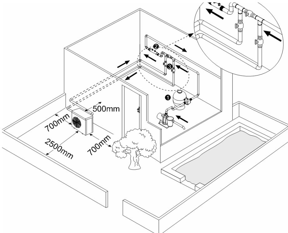
**Gain de temps à l'installation et rendement optimal de la PAC en toutes saisons, sans aucun réglage !**
